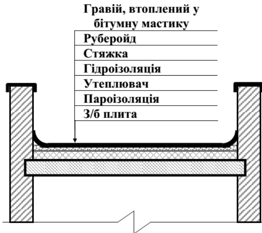
Рисунок 3.25 - Схема суміщеного покриття, що не вентилується
